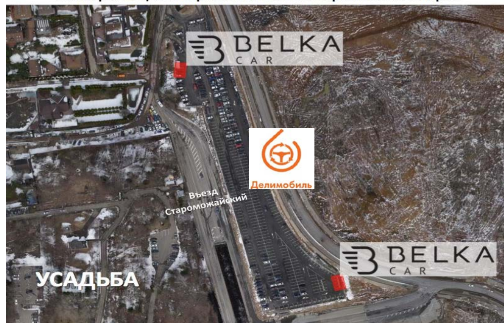
Схема установок зарядных станций на территории ИЦ «Сколково»
